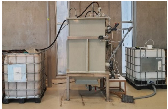
Bild 21. Försöksuppställning med membranfilter på RecoLab, Helsingborg.
