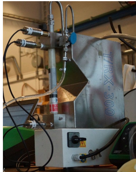
Bild 6. Membranenheten som använts för dagvattenförsök i labbskala.
