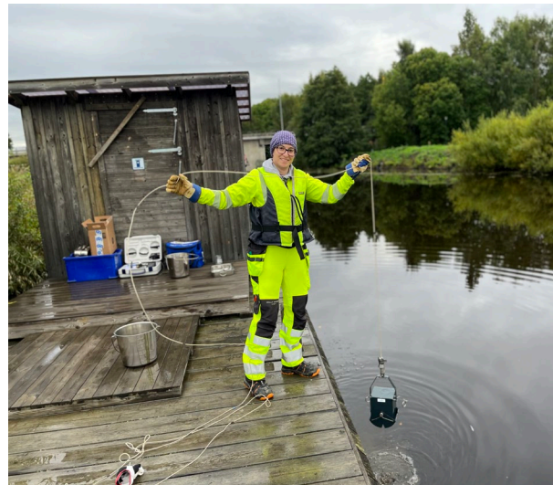
Bild 1. Användning av Ekmanprovtagare för sedimentinsamling vid provtagning i Fyrisån, Uppsala (september 2023).
