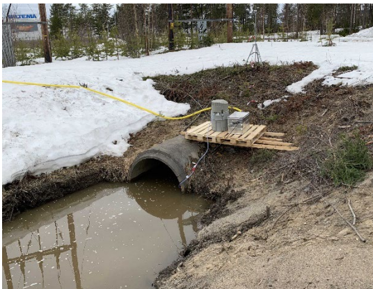
Bild 13. Provtagning av dagvatten på Storhedens industriområde, Luleå
