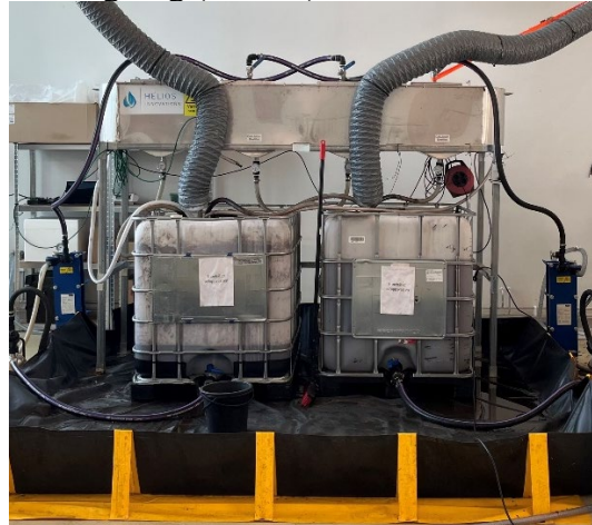
Bild 20. Försöksuppställning med evaporator i pilotskala, RecoLab.
