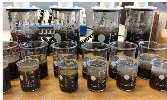
Bild 10: Avvattning av sediment från dagvattendamm och analys av rejecktattnet. Miljölaboratorium, Luleå tekniska universitet.
