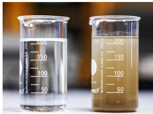
Bild 7. Dagvatten/permeat efter behandling med membran-teknik (t.v.) respektive orenat dagvatten (t.h.)
